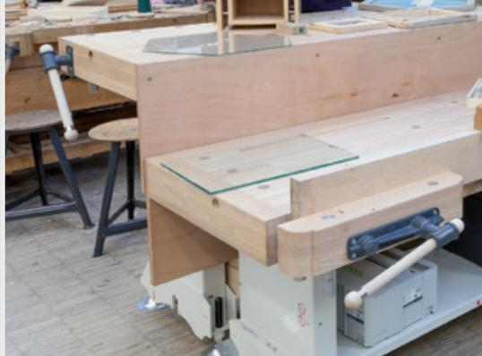
Sicher und praktikabel: Die am Tisch senkrecht montierte Schutzplatte verhindert das Einklemmen bei zwei zueinander gestellten Tischen in der Höhenveränderung. Zudem ist der Hobelbanktisch Resistent gegen Schläge und Vibrationen.
