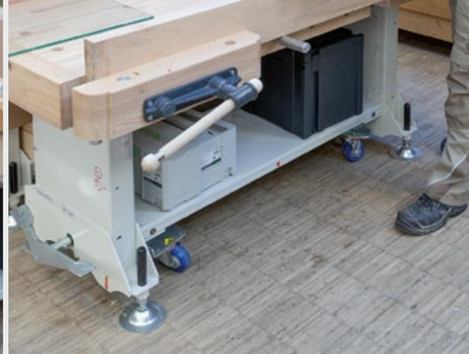
Feststehend aber mobil: Ein Fahrwerk mit Rollen und Hebe-/Senkeinrichtung sorgt für Mobilität. Bei Bedarf werden sie eingezogen – ErgoPlan ruht dann auf stabilen Füßen.
