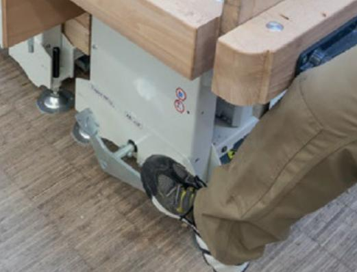
Höhenverstellung über Fußhydraulik: Ein zentral angebrachter Fußhebel ermöglicht schnelles Heben und Senken des Hobelbanktisches – ohne Stromzufuhr.
